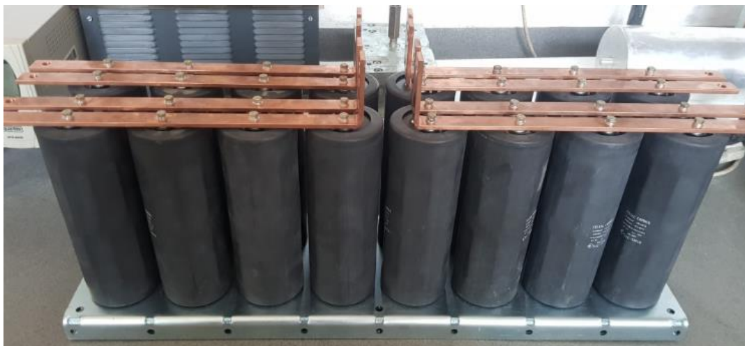
Fig. 8.1. Modulele de condensatoare ale sursei de energie ale actuatorului electromagnetic cu magneți permanenți
